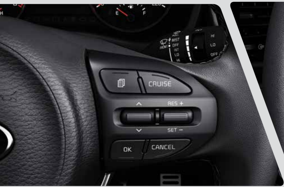
בקרת שיוט אוטומטית* ניתן להפעיל את תפקוד בקרת השיוט האוטומטית באמצעות מתגים על גלגל ההגה, וכך להקל עליך לקבוע את המהירות הרצויה בצורה בטוחה. *בדגם 5 דל' בלבד.
