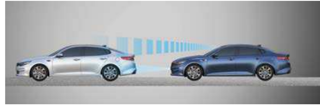
בלימת חירום אוטונומית (AEB) מערכת בלימת החירום האוטונומית מזהה הן כלי רכב שנמצאים לפניך והן הולכי רגל שחוצים את הכביש. המערכת, המשתמשת בחיישנים ובמצלמה כדי לנטר את המהירות והקרבה של כלי הרכב, מעניקה התראה לנהג אם היא מזהה אפשרות של התנגשות. אם הנהג אינו מגיב, המכונית בולמת באופן אוטומטי ומונעת התנגשות או מפחיתה את חומרתה.
