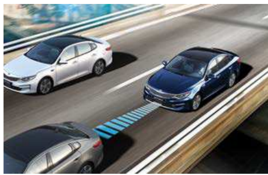
מערכת בקרת שיוט "חכמה" מתקדמת (ASCC) מערכת בקרת השיוט ה"חכמה" והמתקדמת משתמשת בחיישן רדאר בחזית המכונית כדי לנטר את המרחק לכלי הרכב שנוסעים לפניך. אם המרחק הבטוח שנקבע מראש אינו נשמר, המערכת תפחית את מהירות הנסיעה, ואפילו תעצור את המכונית, עד שהרכב מלפנים ימשיך להתקדם.
