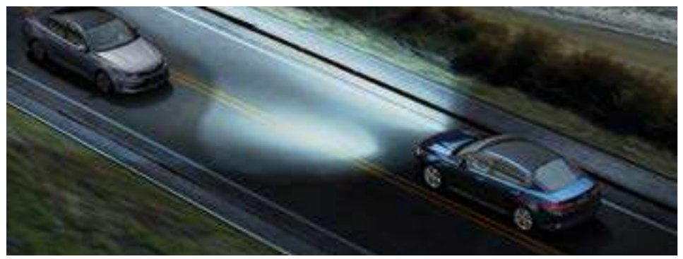
סיוע לאלומה גבוהה (HBA) מצלמה הממוקמת על השמשה הקדמית מזהה כלי רכב הנוסעים מלפנים, ומערכת הסיוע לאלומה גבוהה מעבירה באופן אוטומטי בין אלומה גבוהה לאלומה נמוכה בהתאם לתנאי הנהיגה.
