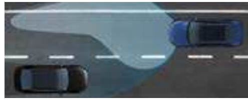
סיוע לאלומה גבוהה (HBA) מצלמה הממוקמת על השמשה הקדמית מזהה כלי רכב הנוסעים מלפנים, ומערכת הסיוע לאלומה גבוהה מעבירה באופן אוטומטי בין אלומה גבוהה לאלומה נמוכה בהתאם לתנאי הנהיגה.
