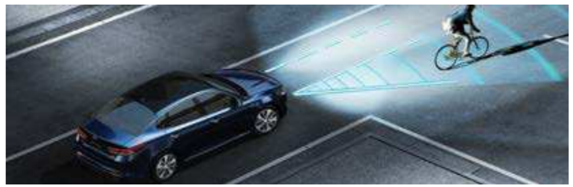
מערכת תאורה קדמית מסתגלת (AFLS) אין מצב שתישאר בחושך. מערכת AFLS מכוונת את האלומה הנמוכה כך שתעקוב אחרי הפניות כשהמכונית פונה, לשיפור הראות בלילה. היא מתאימה את עצמה למהירות הנסיעה ולזווית הפניה.
