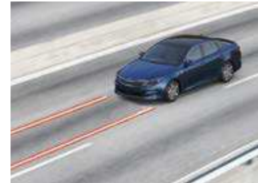
מערכת התראה על סטייה מנתיב (LDWS) מערכת סיוע לשמירה על הנתיב מזהירה אותך כדי לשמור אותך בדיוק במקום בו אתה צריך להיות.
