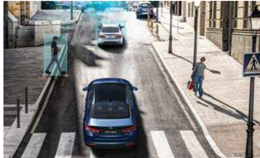
בלימת חירום אוטונומית (AEB) מערכת בלימת החירום האוטונומית מזהה הן כלי רכב שנמצאים לפניך והן הולכי רגל שחוצים את הכביש. המערכת, המשתמשת בחיישנים ובמצלמה כדי לנטר את המהירות והקרבה של כלי הרכב, מעניקה התראה לנהג אם היא מזהה אפשרות של התנגשות. אם הנהג אינו מגיב, המכונית בולמת באופן אוטומטי ומונעת התנגשות או מפחיתה את חומרתה.
