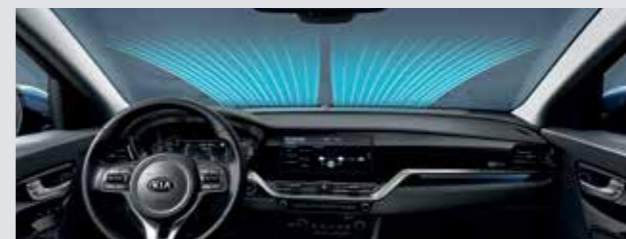
מערכת הפשרת אדים אוטומטית חיישנים מזהים כל הצטברות של אדים בחלק הפנימי של השמשה הקדמית. המערכת מפעילה באופן אוטומטי את מפשר האדים לשמירה על ראות ובטיחות מרביות.
