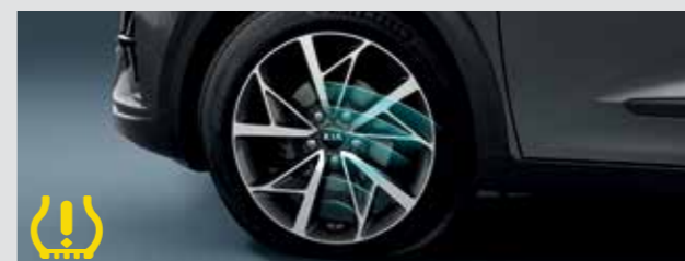
מערכת לניטור לחץ האוויר בצמיגים (TPMS) מערכת TPMS עוקבת אחרי לחץ האוויר בתוך כל אחד מהצמיגים ומידעת אותך במצבם באמצעות הצגת ערך לחץ האוויר בלוח המחוונים.
