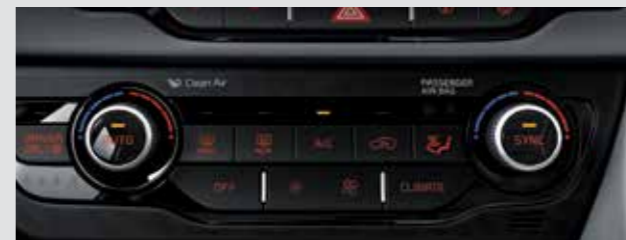
מערכת בקרת אקלים אוטומטית, מפוצלת לשני אזורים (D-FATC) מערכת D-FATC מפעילה ומכבה את מיזוג האוויר כדי לשמור על טמפרטורות שונות עבור הנהג והנוסע הקדמי.
